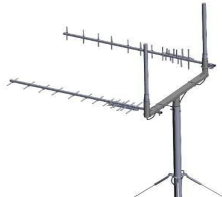
Рис.Б.4 Вариант установки антенн Комплекта АФО (коллинеарный) АДГЕ.425551.089 и ANT 815 LY на мачте
