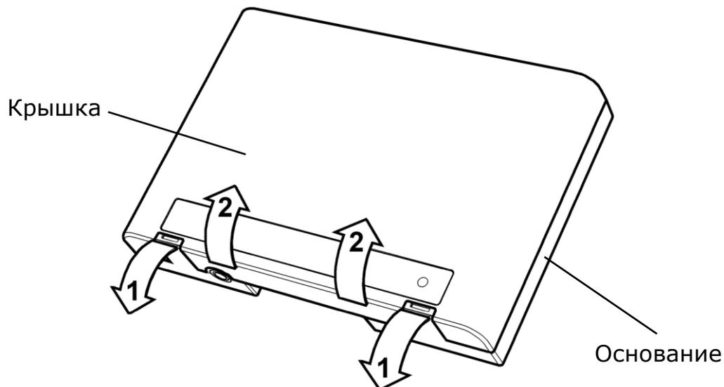
Для того, чтобы закрыть корпус, необходимо сначала зацепить крышку за основание сверху, а потом полностью закрыть прибор.
