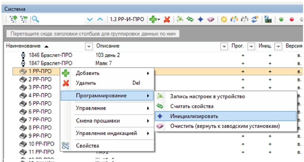
5. Проверить соответствие серийного номера устройства (последние четыре символа) в окне программирования и нажать кнопку "Запрограммировать".
