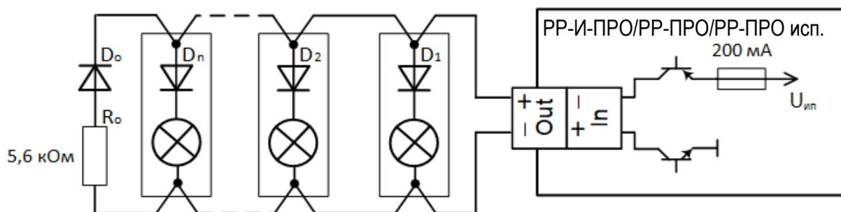
Оконечные диод  $D_0$  и резистор  $R_0$  рекомендуется устанавливать в непосредственной близости от корпуса последнего устройства-нагрузки, а диоды  $D_1, D_2, \dots, D_n$  устанавливать внутри корпуса устройства-нагрузки (для световых оповещателей установка  $D_1, D_2, \dots, D_n$  не требуется).
