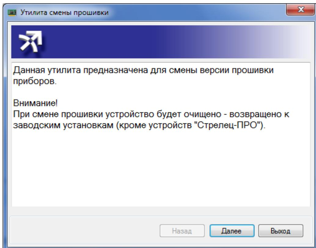
Смена прошивки контроллеров РР-И-ПРО выполняется через интерфейс USB или S2. Смена прошивки контроллеров РР-ПРО выполняется через Программатор-ПРО (приобретается отдельно).
