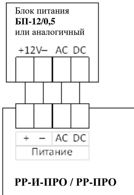
Для питания контроллеров возможно использование резервированного блока питания "БП-12/0,5" с несущей панелью, позволяющей закрепить прибор непосредственно на блоке питания и выполнить все соединения внутри корпуса.
