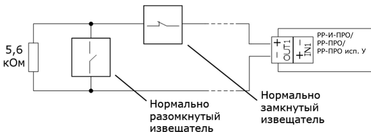
Схема подключения **нормально разомкнутых пожарных** извещателей с выходом типа "сухой контакт":
