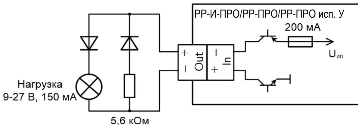
Схема подключения нескольких устройств к выходам типа «Открытый коллектор с контролем цепи до нагрузки»:
