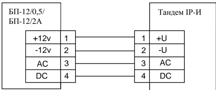
Подключение к блоку питания БП-12/0,5 или БП-12/2А нового образца
