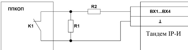
Схема подключения нормально замкнутых выходов пожарной, охранной, тревожной, технологической сигнализации.
