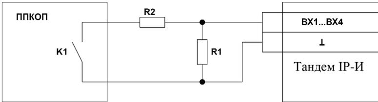
Схема подключения нормально разомкнутых выходов пожарной, охранной, тревожной, технологической сигнализации.
