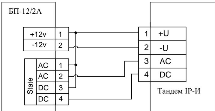
Подключение к блоку питания БП-12/2А старого образца
