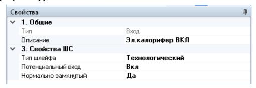
Нарушение/тревога по данному входу означает, что осуществлен успешный пуск соответствующего исполнительного устройства:
