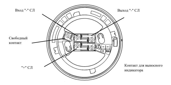
Подключение извещателей СПК-Д, СПК-ДТ, СПК-Т и оповещателя СПК-30:
