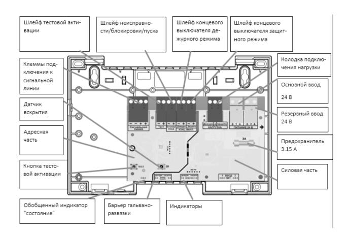
Исполнительный блок адресный **СПК-ИБ1** предназначен для управления пожарной автоматикой, оповещателями и другими исполнительными устройствами
