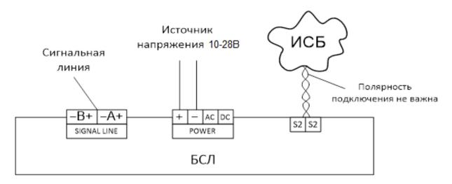
При установке нескольких БСЛ рядом рекомендуется подключать их к разным блокам питания и прокладывать сигнальные линии отдельно.
