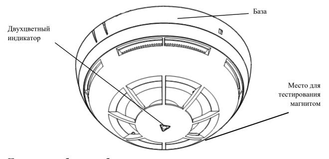
Проверка работоспособности производится поднесением постоянного магнита к краю корпуса извещателя в область, противоположную обозначенной метками на базе.
