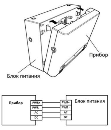
Для обеспечения двух вводов питания допускается включение двух внешних блоков питания по следующей схеме:
