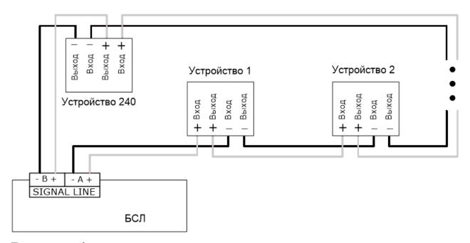
**Внимание!** Для устройств, включаемых в СЛ, деление контактов сигнальной линии на вход и выход условное, плюсовые контакты СЛ равнозначны между собой, как и минусовые.
