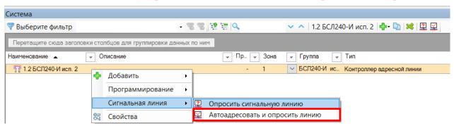
Автоадресация пройдет корректно только в том случае, если все устройства в линии имеют изоляторы, они исправны, подключены корректно, а сама линия подключена кольцом.
