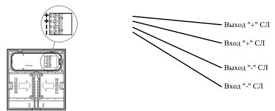
У пожарных извещателей **СПК-Д, СПК-ДТ, СПК-Т** и оповещателя **СПК-ЗО** "Вход +" и "Выход +" СЛ объединены:
