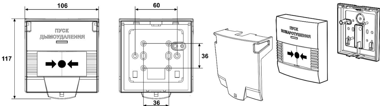
Примечание: установка УДП допускается только на вертикальные поверхности отверстием для ключа сброса вниз.
