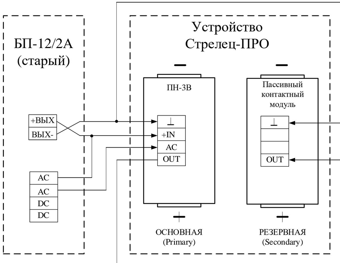
Рисунок 3 - Подключение ПН-3В с контролем внешнего источника питания
