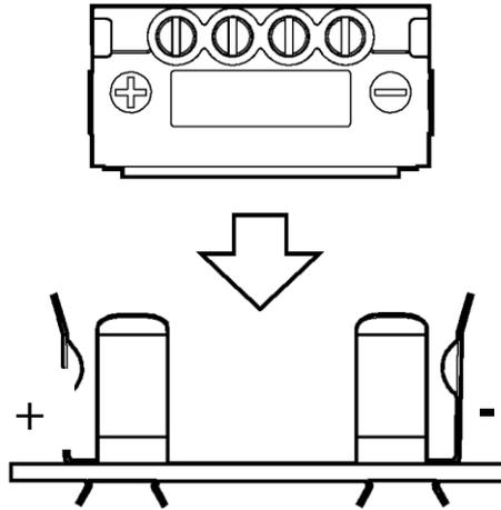
Рисунок 5 - Установка ПН-3В в разъем CR123A
