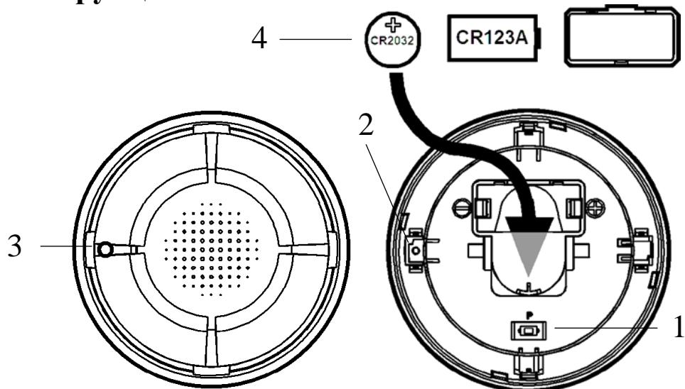
1 – Кнопка "ПРОГ" для инициализации устройства; 2 – Датчик снятия с базового основания; 3 – Светодиодный индикатор; 4 – Основная и резервная батареи
