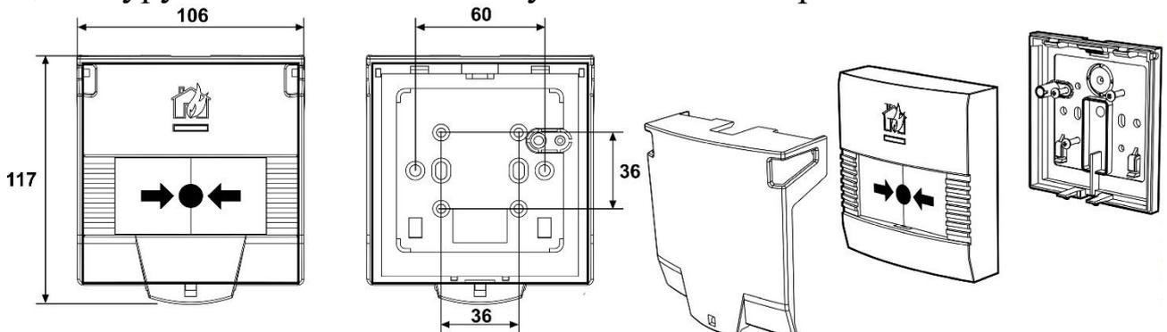
Защитная маска ИПР служит для защиты приводного элемента от случайного воздействия. При необходимости возможно пломбирование маски ИПР с целью ограничения доступа к приводному элементу. Пломбирование может осуществляться с помощью липкой пломбировочной индикаторной ленты, либо с помощью тросовой пломбы. В последнем случае необходимо использовать вставку, как показано на рисунке ниже.
