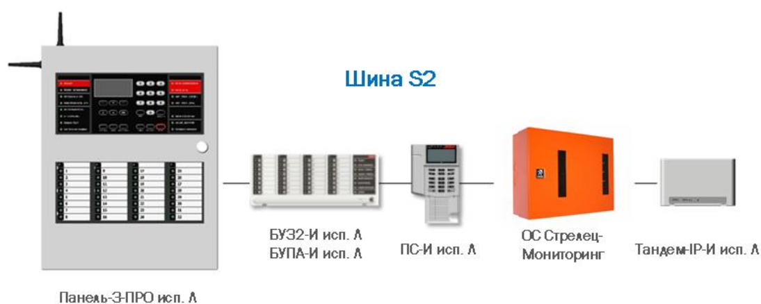
Рисунок 6 Подключение устройств по шине S2 к Панели-3-ПРО исп. Л
