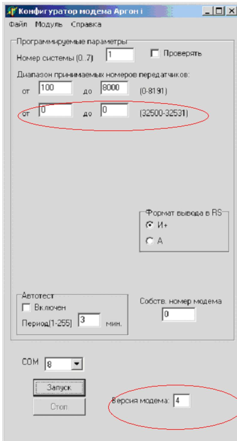
Если номер передатчика не попадает ни в один из диапазонов, извещение от него игнорируется.
