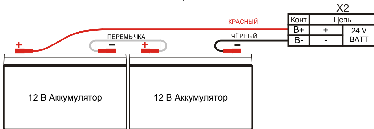
Рис. 64 (Схема подключения электропитания БПК-2)
