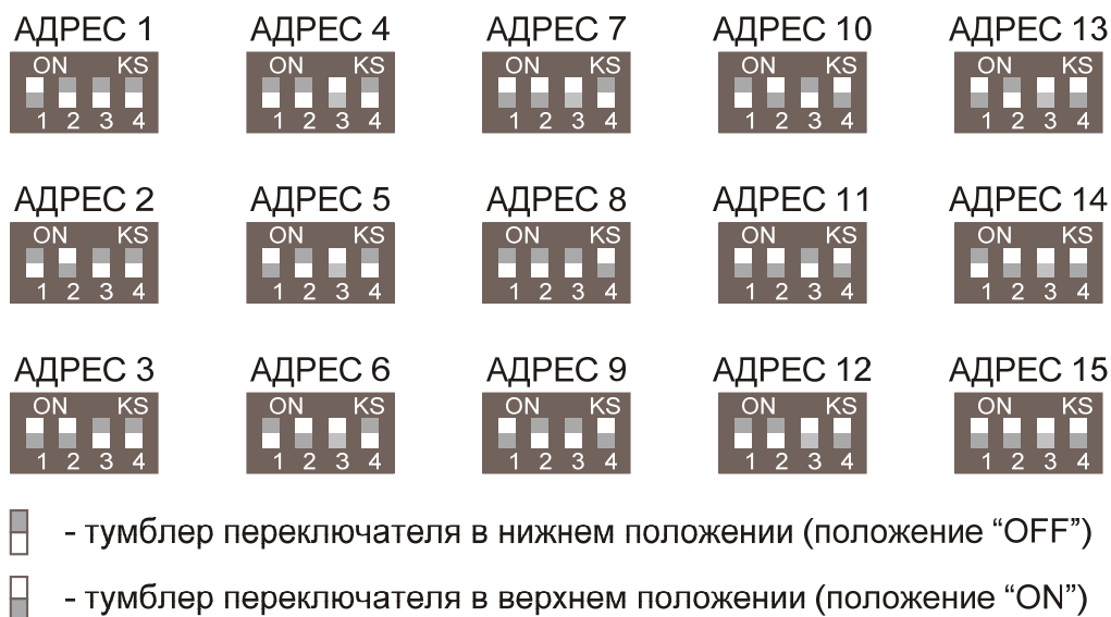
Рис. 19 (Установка адреса БКЛ с помощью DIP переключателя «S1»)
