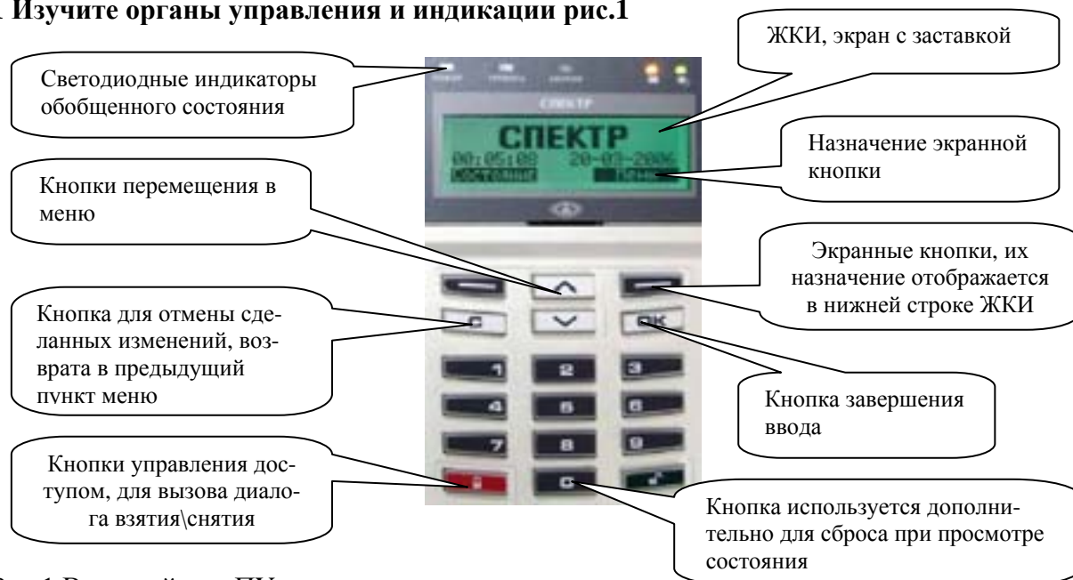
Рис.1 Внешний вид ПУ, органы управления
