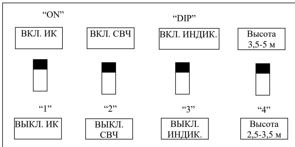
Рисунок 1 - Положения движков при различных режимах работы.
