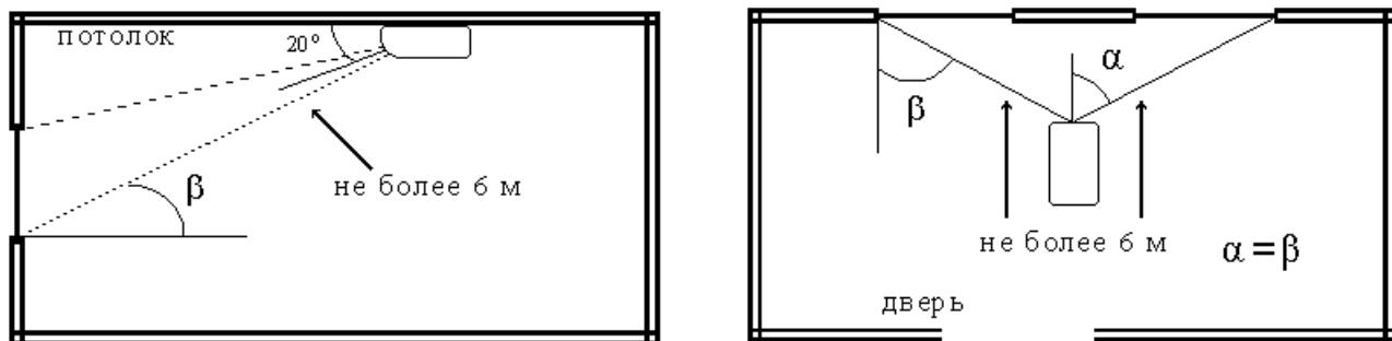
Рисунок В.2 – Установка на потолке
