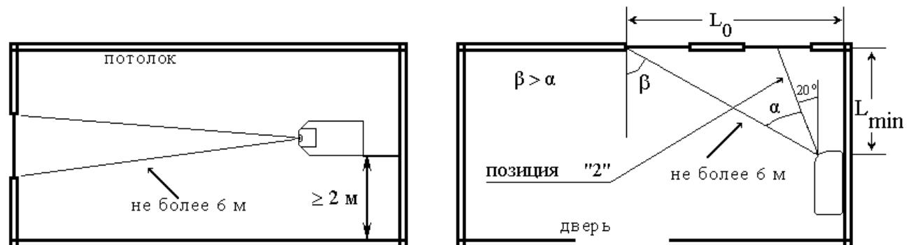
Рисунок В.5 – Установка на боковой стене (позиция микрофона "2")
