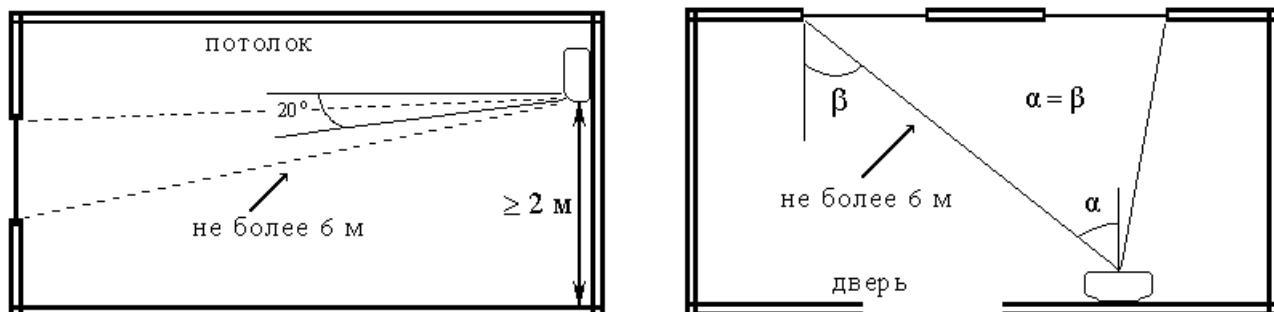
Рисунок В.3 – Установка на противоположной стене
