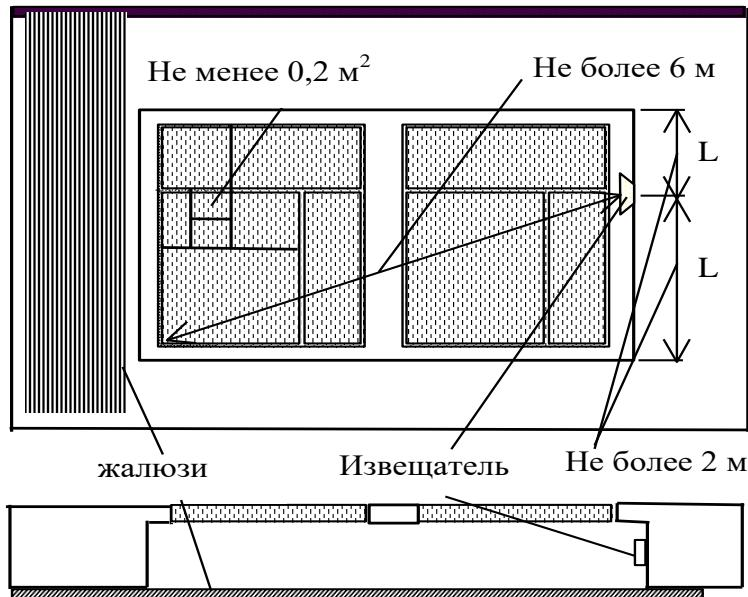
Рисунок В.6 – Установка на торце оконного проема
