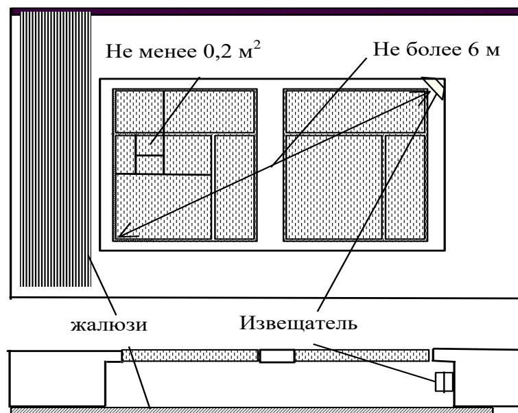
Рисунок В.7 – Установка в углу оконного проема
