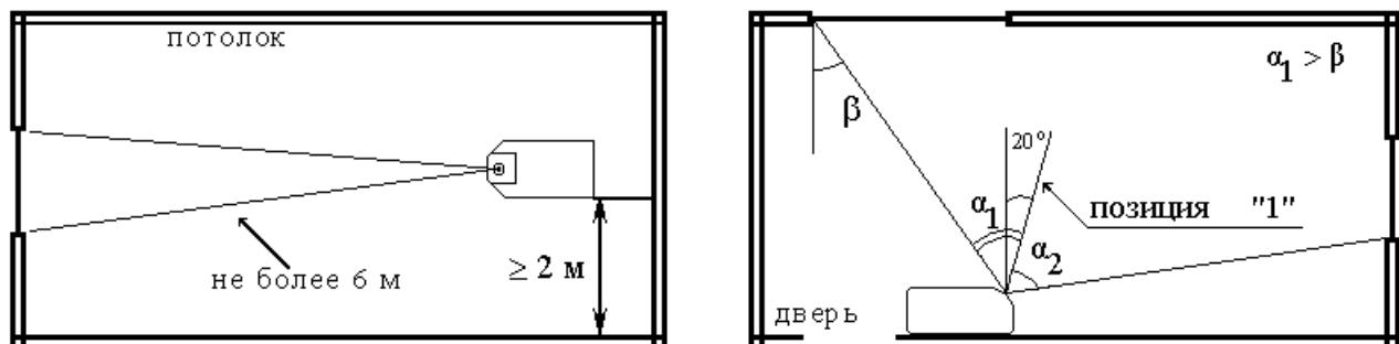
Рисунок В.4 – Установка на боковой стене (позиция микрофона "1")
