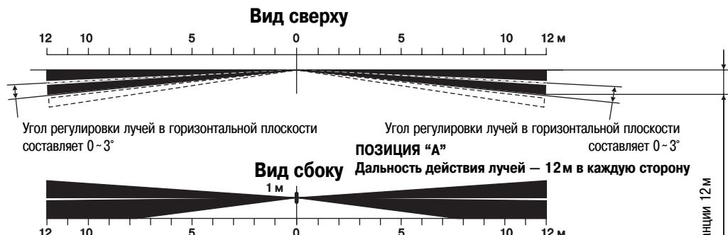
Регулировка лучей в горизонтальной и вертикальной плоскости осуществляется независимо для обоих сторон (см. Секц. 7: "Настройка диапазона детекции").
