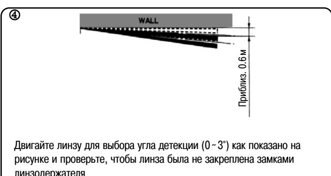
Двигайте линзу для выбора угла детекции (0 ~ 3°) как показано на рисунке и проверьте, чтобы линза была не закреплена замками линзодержателя
