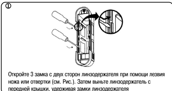
Откройте 3 замка с двух сторон линзодержателя при помощи лезвия ножа или отвертки (см. Рис.). Затем выньте линзодержатель с передней крышки, удерживая замки линзодержателя
