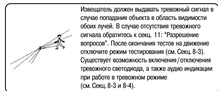
Извещатель должен выдавать тревожный сигнал в случае попадания объекта в область видимости обоих лучей. В случае отсутствия тревожного сигнала обратитесь к секц. 11: "Разрешение вопросов". После окончания тестов на движение отключите режим тестирования (см. Секц. 8-3).
