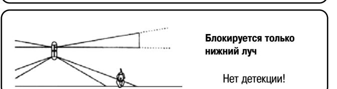
Установите угол наклона, перемещая нижнюю линзу как показано на рис. (угол наклона регулируется независимо для обоих сторон).
