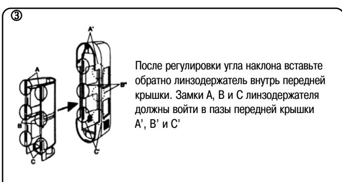
После регулировки угла наклона вставьте обратно линзодержатель внутрь передней крышки. Замки А, В и С линзодержателя должны войти в пазы передней крышки А', В' и С'
