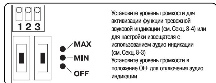
Установите уровень громкости для активизации функции тревожной звуковой индикации (см. Секц. 8-4) или для настройки извещателя с использованием аудио индикации (см. Секц. 8-3)
