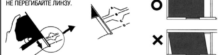
Выньте линзодержатель с передней крышки (см. Секц. 7-1: "Установка угла наклона") Установите положение нижней линзы по меткам, нанесенным на линзодержателе (A, B, C или D).
